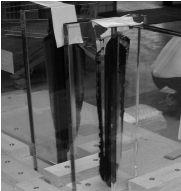
Bild 14: Versuche f. d. verklebte Dachverglasung einer Glasbrücke. (FHM) Fig. 14: Tests for a bonded roof glazing of a glass bridge
