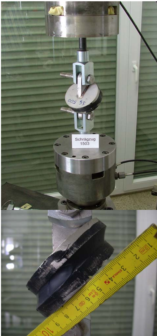
Bild 32: Versuchsaufbau für Schrägzugversuch Fig. 32: Test configuration for shear-tension test
