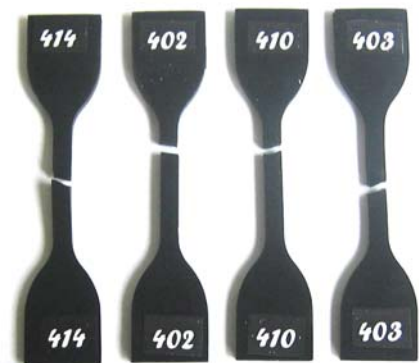
Bild 8: Zerstörte Zugversuchskörper Fig. 8: Failed specimen for tension test
