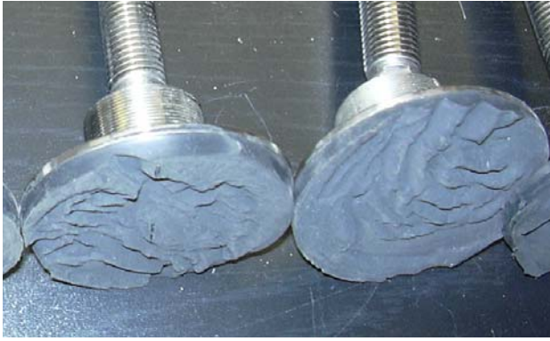
Bild 31: Zerörter Punkthalter, Zugversuch Fig. 31: Failed point support, tension test
